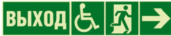
Рисунок 5 - Пример комбинации эвакуационных знаков
