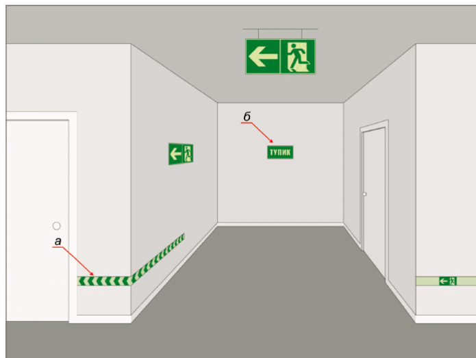
Рисунок В.8 - Пример обозначения совмещенного основного пути эвакуации и пути эвакуации для инвалидов-колясочников в коридорах, проходных помещениях и т.п.
