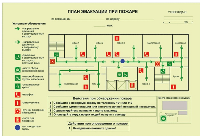
Рисунок 9 - Пример плана эвакуации
